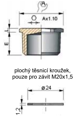
zátká Ex d nerez/mosaz připojovací závit M20x1,5 a 1/2-14 NPT
