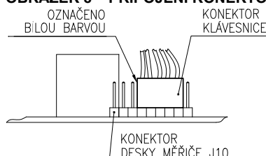
OBRÁZEK 8 – PŘIPOJENÍ KONEKTORU KLÁVESNICE
