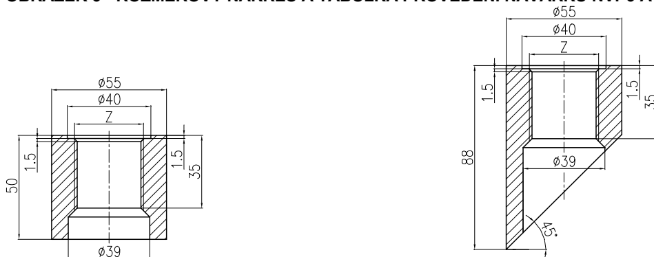
OBRÁZEK 5 - ROZMĚROVÝ NÁKRES A TABULKA PROVEDENÍ NÁVARKŮ NVP5 A NVS5
