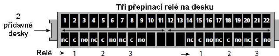
OBRÁZEK 8 - ZAPOJENÍ RELÉOVÉ DESKY
